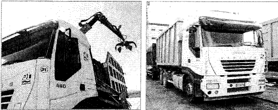
Motrice attrezzata con cassone scarrabile e grigno caricatore
